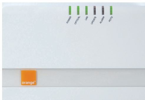
Obr. 13: Signalizácia diód pri zodvihnutom telefóne
