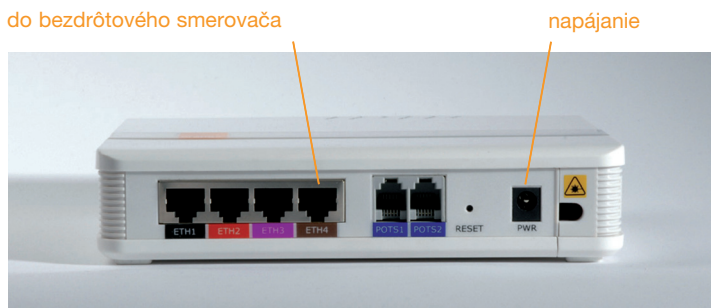
Obr. 4: Pripojenie káblu do Konvertora
