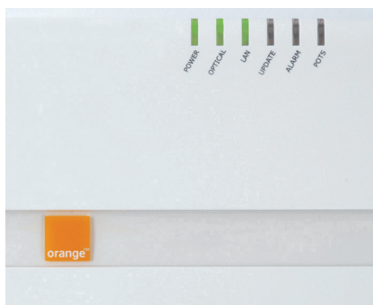
Obr. 6: Signalizácia diód – Konvertor
