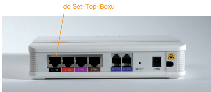
Obr. 9: Pripojenie káblu do Konvertora
