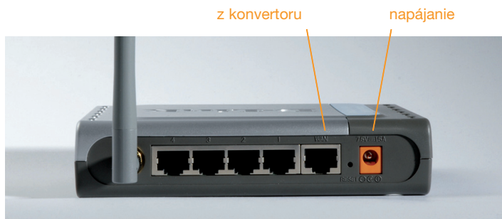
Obr. 5: Priporenie káblu do Bezdrôtového smerovača
